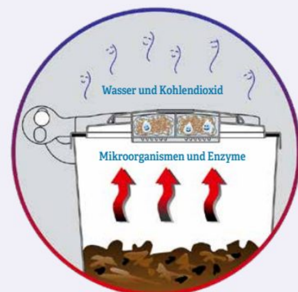
Biologischer Abbau – Funktion des Biofilters
